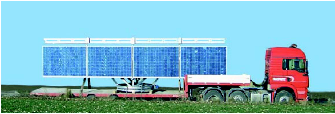
Abbildung 3: Transport eines Solon-Movers mit eingeklappten Modulreihen (Quelle: Solon AG 2006)
